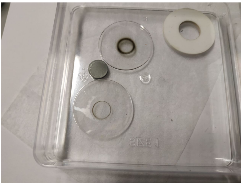
FIGURE V.51. – Photo de la pastille, des saphirs et de l’anneau en zircone après la série de chauffes type annulaire
