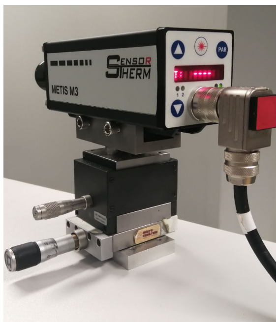
FIGURE III.16. – Photo d'un pyromètre sur un support à 2 axes réglables (XZ)
