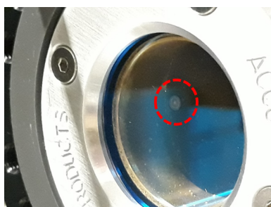
FIGURE V.11. – Photo d'un endommagement d'un hublot de la chambre placé dans la zone du point chaud
