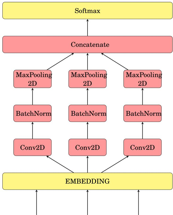
FIGURE III.4 – Réseau CNN
