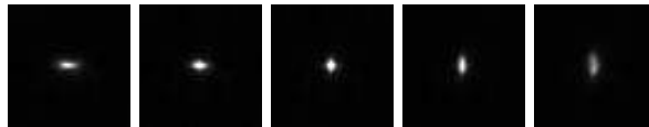
(b) Réponse impulsionnelle astigmatique expérimentale. La profondeur varie de gauche à droite de -500\text{nm} à +500\text{nm} , par pas de 250\text{nm} . Les paramètres expérimentaux (longueur d'onde, ouverture numérique, etc) sont différents des simulations précédentes. Cela explique la différence d'échelle entre les figures. Le pixel est de taille 160\text{nm} et la bille de taille 100\text{nm} .
