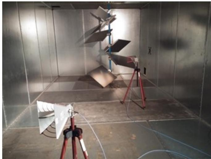
Figure 35 : Mesure d'efficacité d'antenne en CRBM (IETR)
