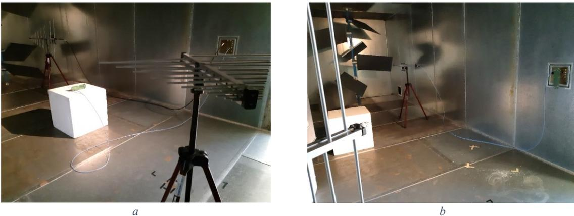
Figure 48 : Photos de la configuration de mesure classique (a) et de la configuration avec câble en ferrite (b)
