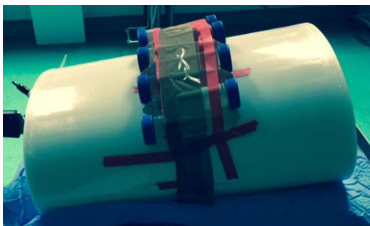
Figure VI-97 : Position des éprouvettes sur le fantôme anthropomorphique thoracique pour la lecture par IRM
