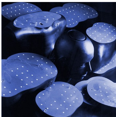
Figure VI-89 : Visualisation des emplacements (points blancs) permettant de positionner des dosimètres thermoluminescents à différents niveaux d'un fantôme de type RANDO® (Supertech, Inc).
