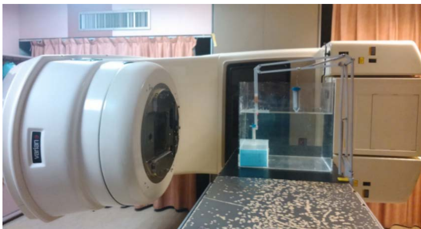
Figure VI-95 : Disposition des tubes à essais pendant l'irradiation
