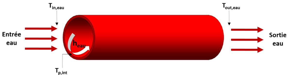
Figure I-14 : Echange convectif à l'intérieur de tube
