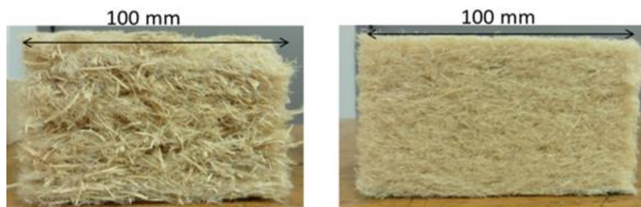
Figure 72 : Vue des sections droites de MNTB réalisés à partir de fibres de pin maritime de granulométries différenciées : PM2S (à gauche) et PM5S (à droite)
