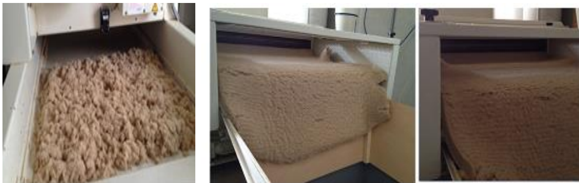
Figure 62 : Dépôt de la matière première sur tapis alimentaire puis vues de face d'une nappe formée
