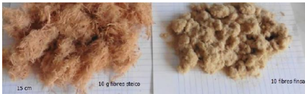
Figure 58 : Visuels des fibres de bois fournies par les 2 industriels du projet
