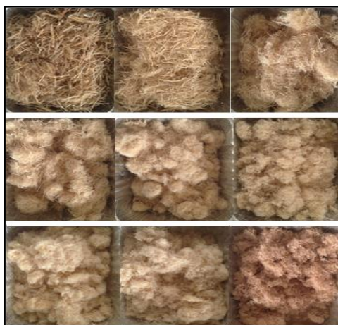
Figure 32 : Sélection de photographies montrant la gamme de granulométries et de couleurs de fibres produites par le FCBA Les 6 premières vont de PM1 à PM6. Les 3 en bas de gauche à droite sont PT5, PR5 et EU5
