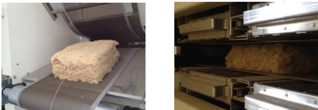
Figure 63 : Visuel d'un matelas à l'entrée du four Strahm puis dans sa phase de refroidissement
