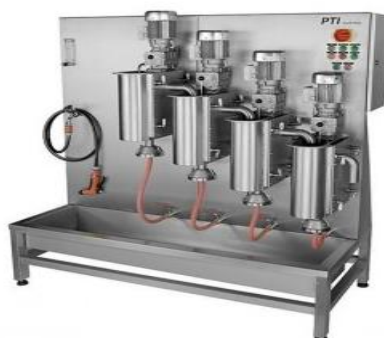
Figure 33 : Vue d'ensemble du Bauer Mac Nett avec ses réservoirs et leurs tailles respectives
