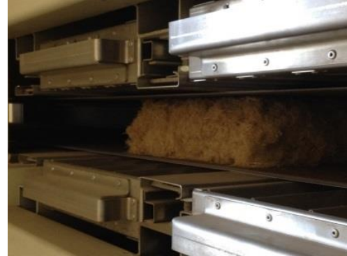
Figure 63 : Visuel d'un matelas à l'entrée du four Strahm puis dans sa phase de refroidissement
