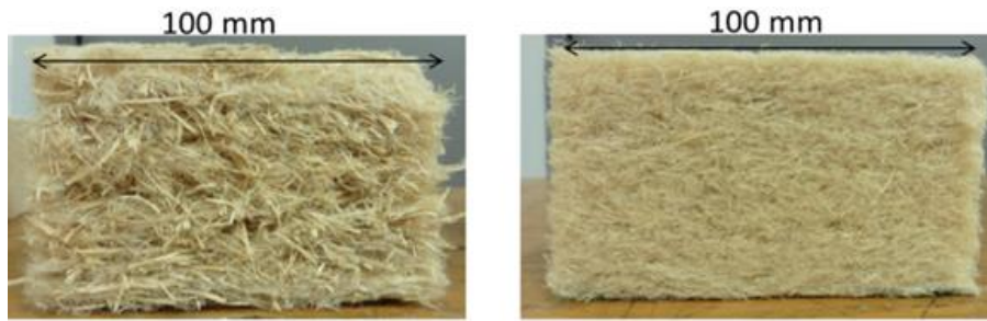
Figure 72 : Vue des sections droites de MNTB réalisés à partir de fibres de pin maritime de granulométries différenciées : PM2S (à gauche) et PM5S (à droite)
