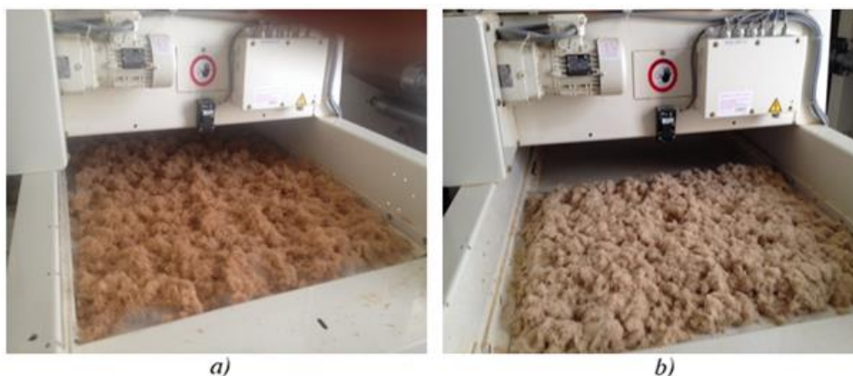
Figure 64 : a) mélange avec fibres de bois de type 1, b) mélange avec fibres de bois de type 5
