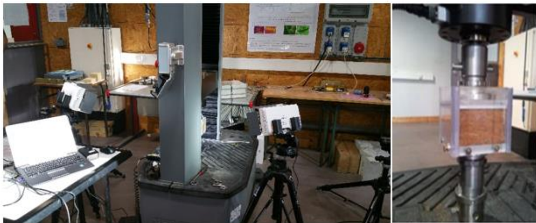
a) b) Figure 56 : Montage d'un essai de compression sur des échantillons (100x100xEpaisseur) a) vue de côté b) vue de face arrière
