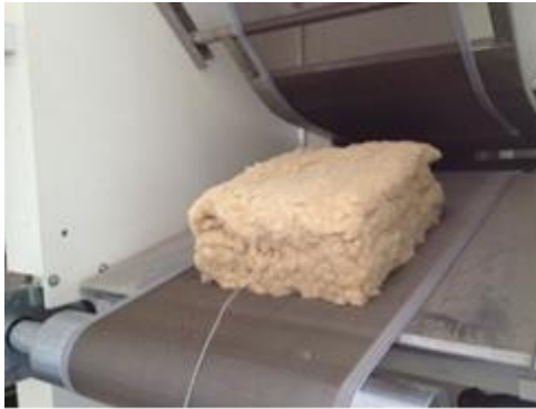
Figure 63 : Visuel d'un matelas à l'entrée du four Strahm puis dans sa phase de refroidissement
