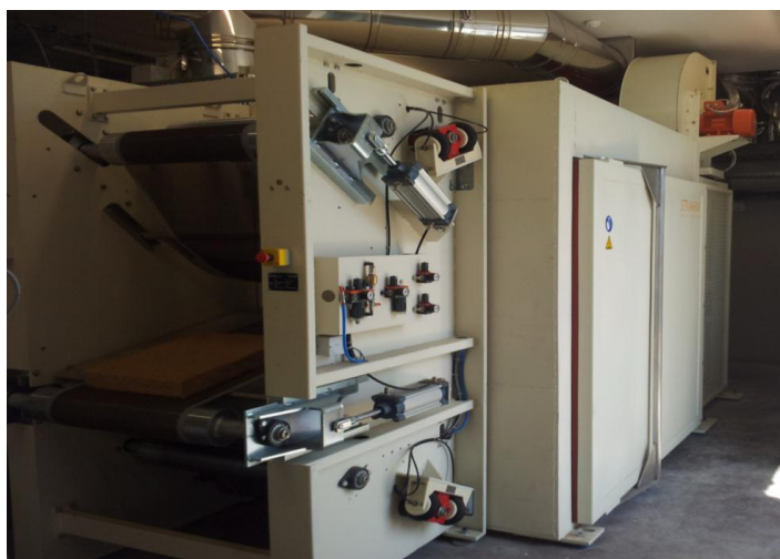
Figure 48 : Vue d'ensemble du four à air chaud Strahm d'I2M à Talence [Equipex Xyloforest]
