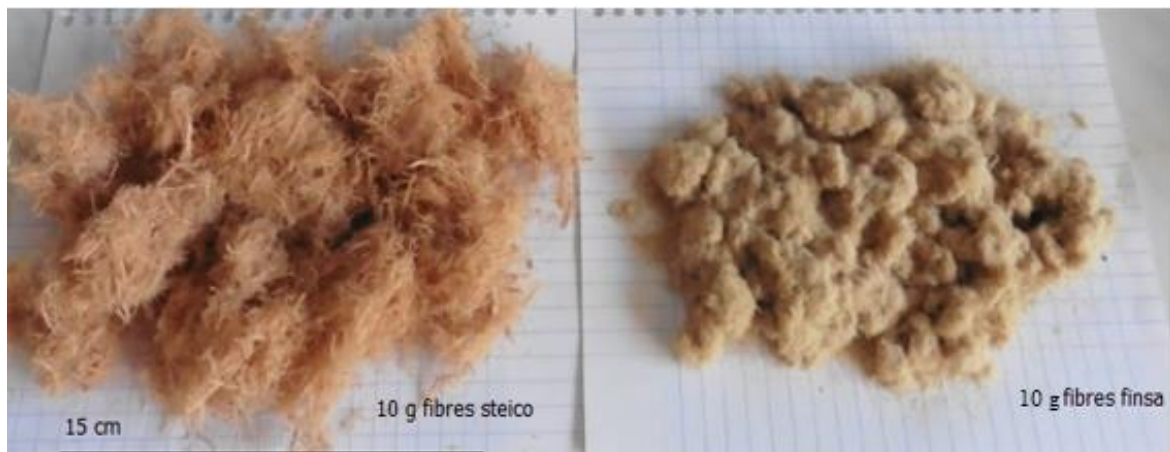
Figure 29 : Fibres de pin maritime de référence venant de STEICO (fibres longues pour l'isolation) et FINSA (fibres courtes pour les MDF)
