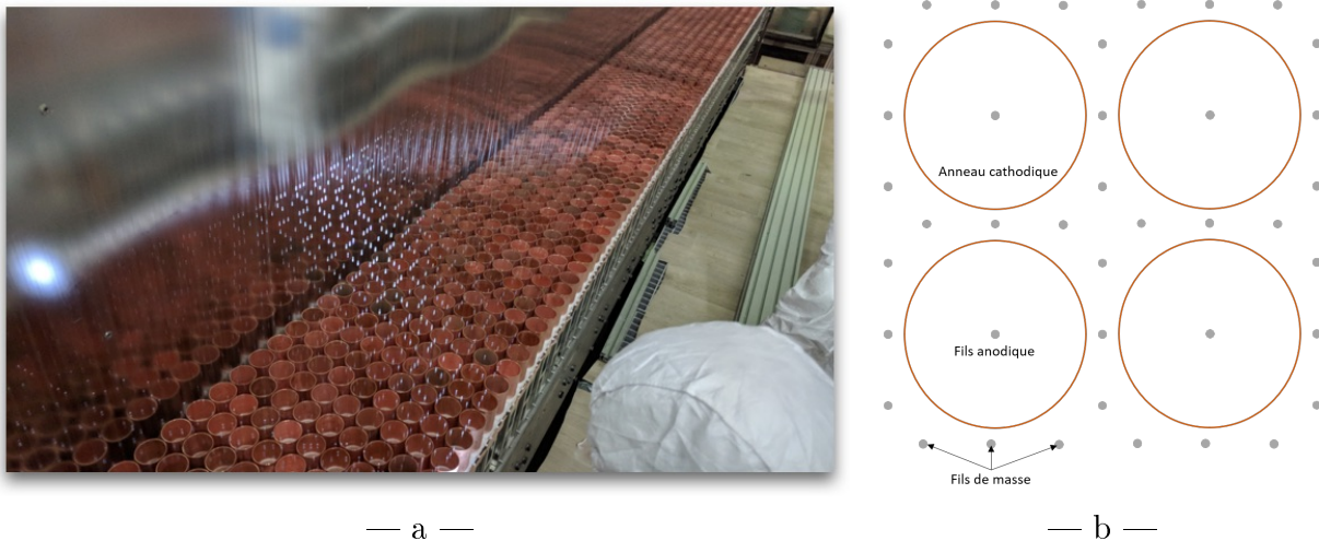
FIGURE 2.6 – Photographie d'une section du trajectographe de SuperNEMO montrant les anneaux cathodiques en cuivre et les fils éclairés (a) et schéma illustrant l'agencement des cellules (b).
