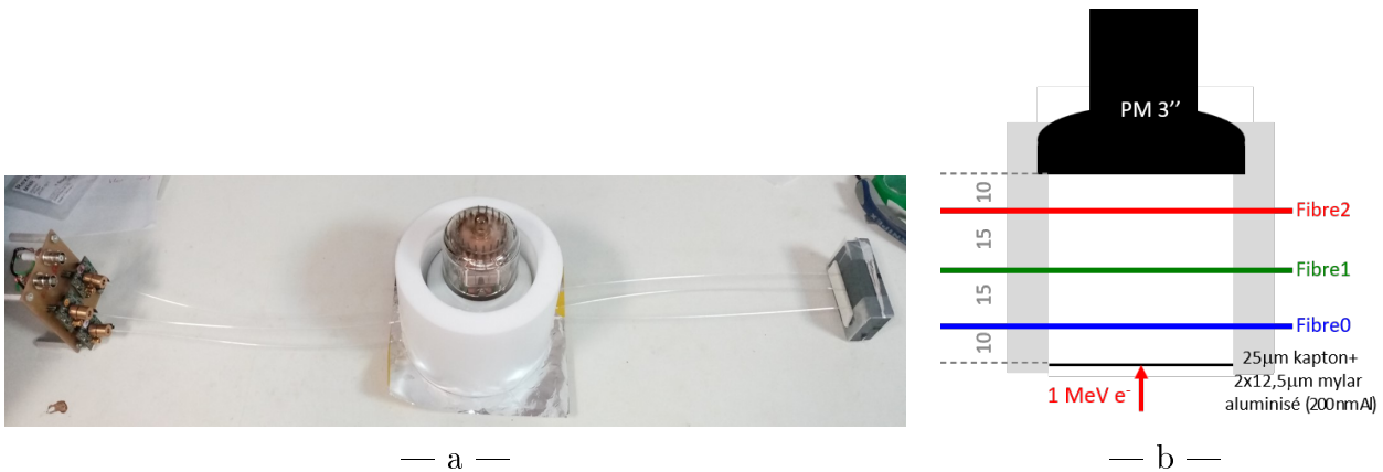
FIGURE 6.17 – Photographie (a) et schéma de principe (b) du prototype \mu -LiquidO.
