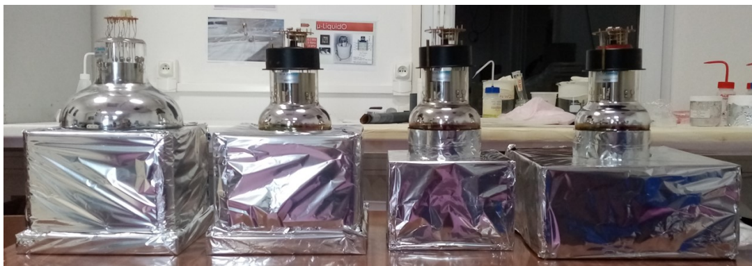
FIGURE 3.2 – Photographie des différentes géométries de modules optiques dans SuperNEMO. De gauche à droite : MWall 8", MWall 5", XWall, GVeto.
