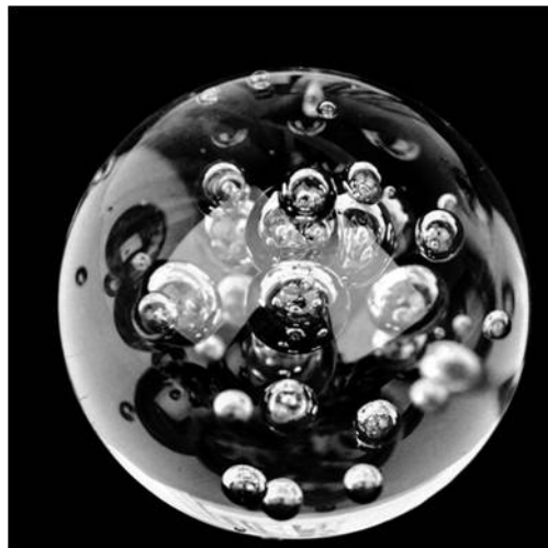
FIGURE 2.1: Photographie tirée de [2] représentant une sphère de verre dans laquelle des inclusions d'air (bulles d'air) sont présentes.
