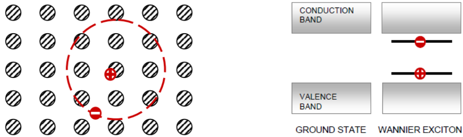
Figure 15 : Représentation de l'exciton de Mott-Wannier et de ses niveaux énergétiques générés au sein d'un semi-conducteur inorganique [31]
