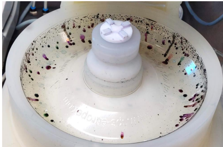
Figure 7 : Photographie du spin-coater en boîte à gants avec maintien mécanique du substrat
