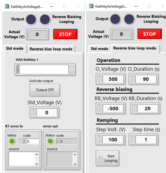
FIGURE 3.9 – Capture de l’interface graphique du programme de pilotage de la source de tension, développé sous LabVIEW. Ce programme est principalement utilisé pour automatiser des inversions périodiques de la polarisation, afin de lutter contre la dégradation du niveau de signal observée au cours du temps.
