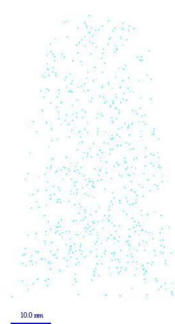
(b) Répartition des atomes d'aluminium (Al) dans le volume reconstruit.
