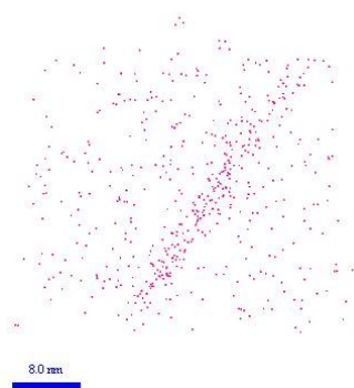
(f) Répartition des atomes de phosphore (P) dans le volume reconstruit.
