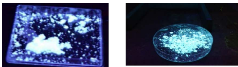
Photographie 2. 2 : Photographies des poudres de C4 à gauche et C6 à droite sous une lampe UV (Excitation à 360 nm); Les deux composés émettent de lumière blanche.
