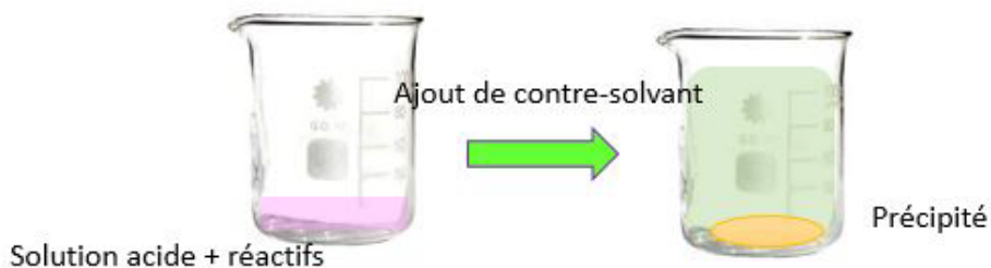
Figure 2. 3 : Exemple de synthèse d'une poudre cristalline par précipitation
