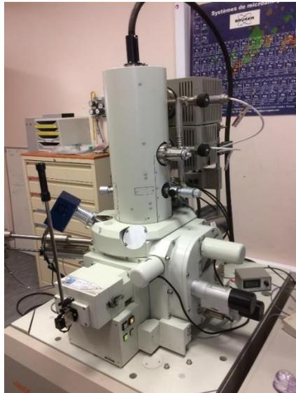
Figure 27 : Photo de l'appareil MEB FEG JEOL JSM-7000F
