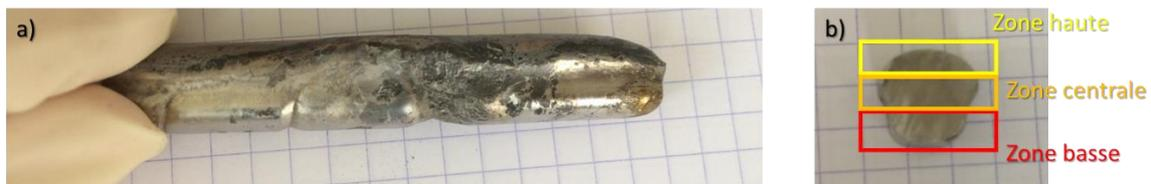
Figure 51 : Echantillon  $(CrFeNi)_{60}Mo_{20}V_{20}$  élaboré au four à induction et mis en forme au four à arc, a) échantillon massif, b) section de l'échantillon. Indications de trois zones en fonction de la vitesse de refroidissement qui décroît du bas vers le haut.
