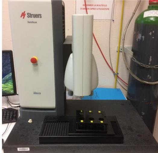
Figure 25 : Photo de l'appareil DuraScan G5
