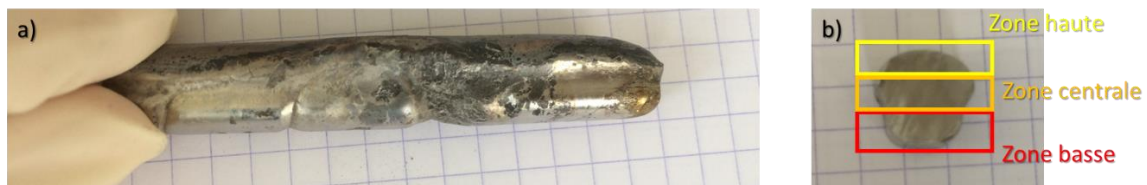
Figure 51 : Echantillon (CrFeNi)_{60}Mo_{20}V_{20} élaboré au four à induction et mis en forme au four à arc, a) échantillon massif, b) section de l'échantillon. Indications de trois zones en fonction de la vitesse de refroidissement qui décroît du bas vers le haut.
