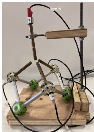
FIGURE 4.7 – Photo de l’antenne tétraédrique CMA Cube développée avec des microphones double couche lors de la thèse d’Aro Ramamonjy [14]
