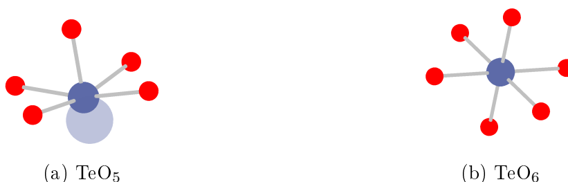
FIGURE 1.10 – Exemples (a) de pyramide à base carrée \text{TeO}_5 et (b) d'octaèdre \text{TeO}_6 retrouvés dans certaines phases cristallisées à base de \text{TeO}_2 . L'atome Te est en bleu, O en rouge et la paire libre de l'atome Te est en bleu transparent.
