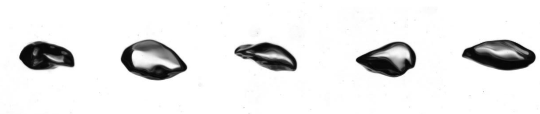
Figure 73 : Acquisition optique (côte à côte) de bulles issues de nos injecteurs (traitées ici spécifiquement pour la visualisation)
