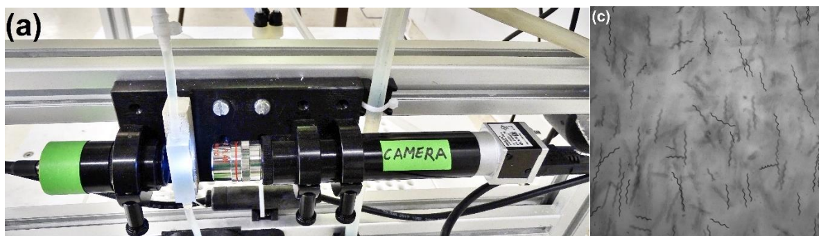
Figure 22 : Photographies : (a) dispositif de microscopie en ligne avec de gauche à droite : une source de lumière LED (scotch vert vierge), une lentille divergente (au niveau de la bague de serrage), la cellule d'écoulement où circule la Spiruline (de bas en haut), un objectif de microscope x4 (EDMUND OPTICS, Micro Plan 4x), tout à droite la caméra (BASLER, acA2040-90um) dont le capteur est dans le plan focal de l'objectif, (b) Image brute délivrée par le dispositif (2000x2000 pixel), le champ d'observation fait 1x1 mm
