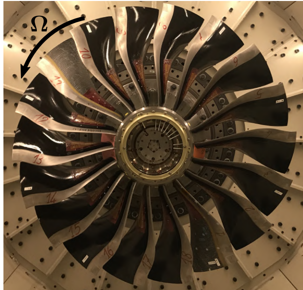
FIGURE VI.3 – Soufflante installée dans le banc d'essais PHARE#1
