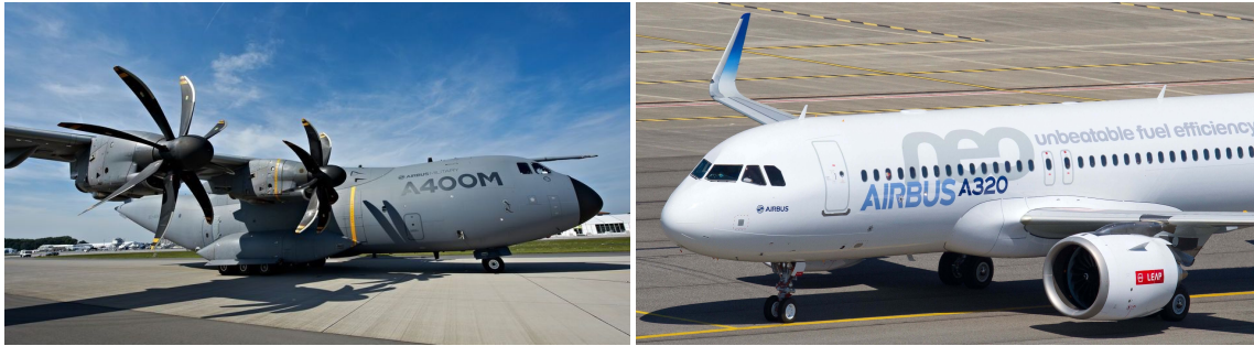
(a) A400M équipé de turbopropulseurs TP-400 (b) A320neo équipé de turboréacteurs LEAP-1A
