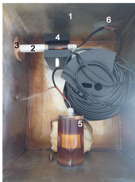
FIGURE 3.9 – Dispositif réalisé pour la mesure de DP sur câble « basse tension ». Intérieur de la boîte blindée.
