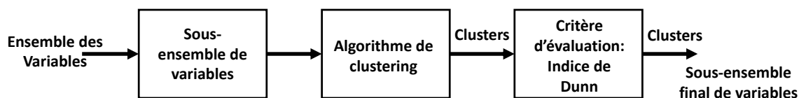
FIGURE 4.17 – Méthodologie implémentée pour la sélection de variables en apprentissage non supervisé.
