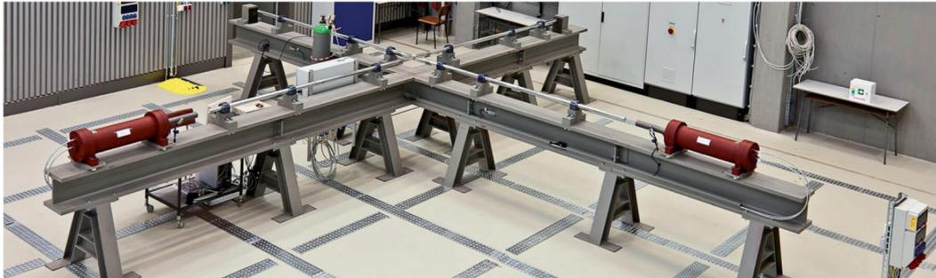
FIGURE 2.17: Éprouvette proposée par [Hummeltenberg et Curbach, 2012] pour des sollicitations de compression bi axiale
