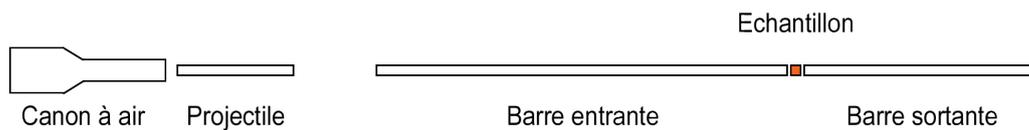
FIGURE 2.1: Principe des barres de Hopkinson en compression
