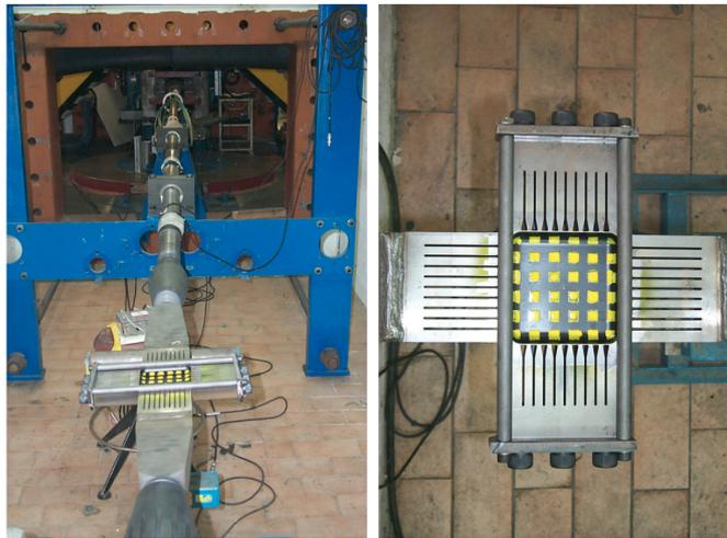
FIGURE 2.15: Éprouvette proposée par [Albertini *et al.*, 2014] pour des sollicitations d'équi-bi-traction
