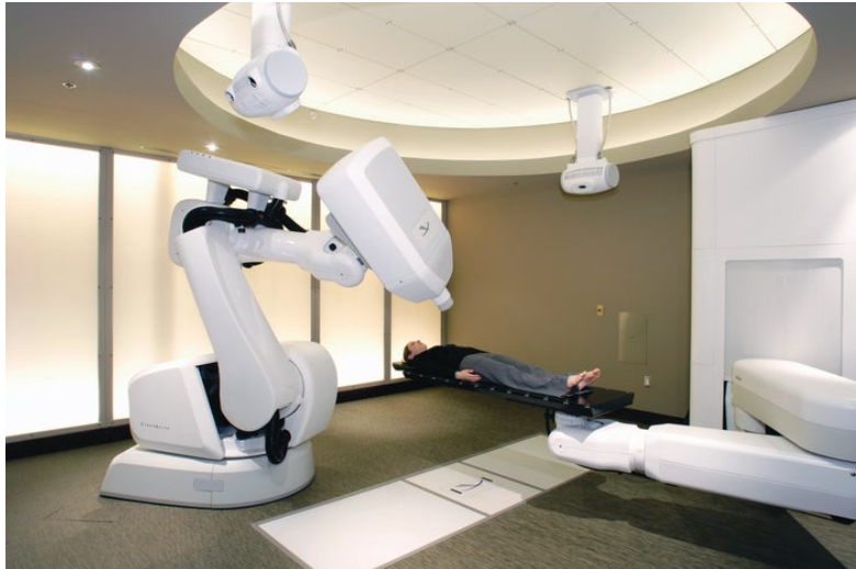
FIGURE 10 – Un appareil de stéréotaxie de type CyberKnife®, sur lequel un accélérateur linéaire miniaturisé est monté sur un bras robotisé. (source : www.deutsches-cyberknife-zentrum.de/en/cyberknife )
