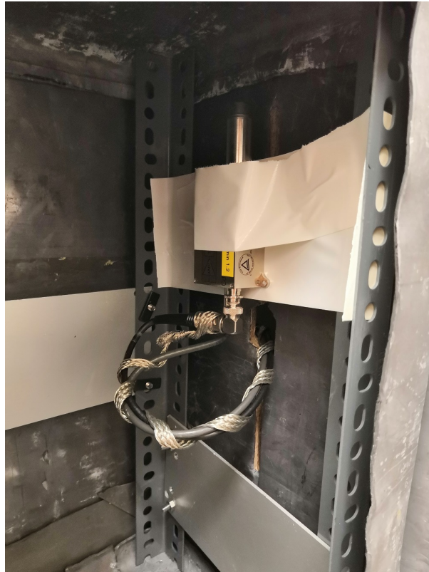
FIGURE 82 – Détecteur CdTe placé hors-champ sans collimation ni banc motorisé pour la mesure du spectre en énergie des photons.
