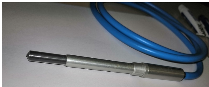
FIGURE 78 – Chambre d'ionisation PTW 30013 Farmer utilisée pour les mesures de dose hors-champ.
