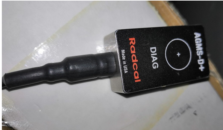
FIGURE 77 – Détecteur Radcal AGMS-D+ utilisé pour les mesures de dose dans le champ.
