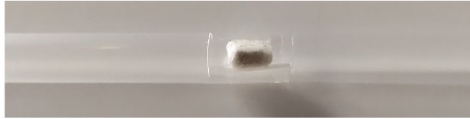
FIGURE 4.4 – Exemple d'échantillon sous forme de barreau, placé dans un papier et fixé avec du scotch dans la paille. Ici, l'échantillon est placé au centre de la paille pour des mesures au SQUID.
