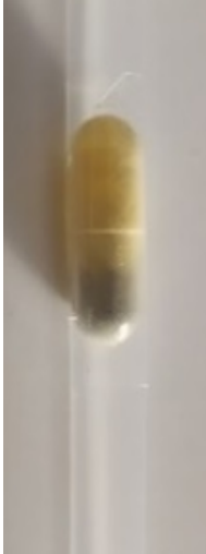
FIGURE 8.1 – Exemple d’une gélule, remplie de mélange de poudre + résine, insérée dans une paille et fixée à l’aide des deux bloqueurs en plastique.
