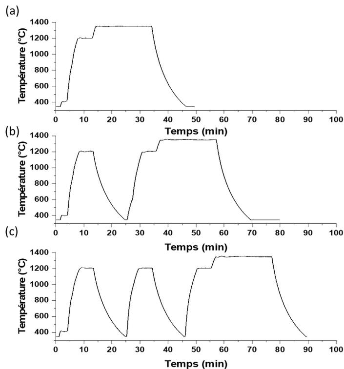
Figure IV-15 : Cycles thermiques réalisés par micro-ondes : une étape de déliantage, (a) une calcination suivie d'un frittage, (b) deux calcinations successives suivies d'un frittage, (c) trois calcinations successives suivies d'un frittage.
