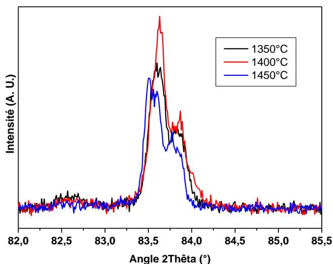
Figure III-10 : Diffractogrammes des céramiques frittées à différentes température avec un zoom sur la réflexion (222).
