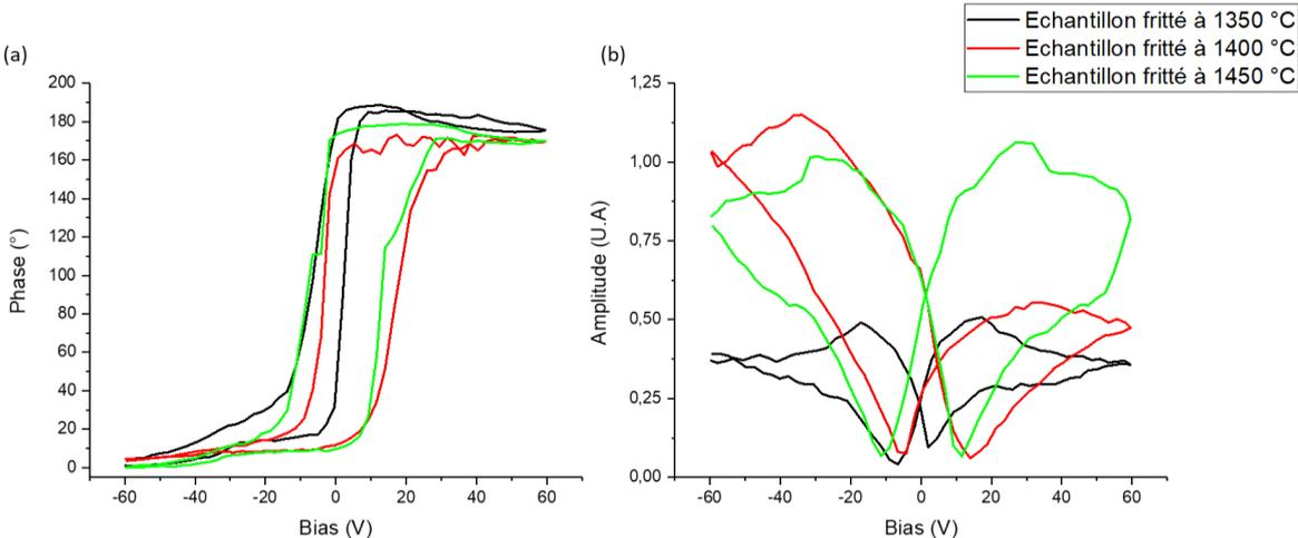
Figure III-24 : Cycles PFM rémanents (a) en phase et (b) en amplitude mesurés à la surface de céramiques frittées à 1350, 1400 et 1450 °C.
