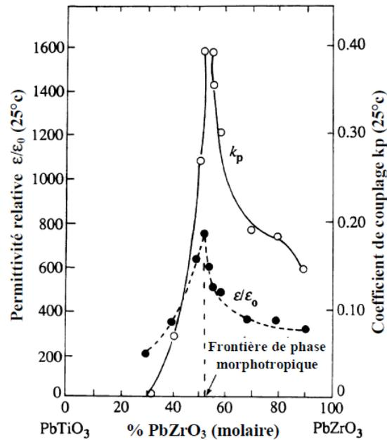
Figure I-13 : Propriétés piézoélectriques et diélectriques des solutions solides de PbZrO<sub>3</sub> et PbTiO<sub>3</sub> [17].
