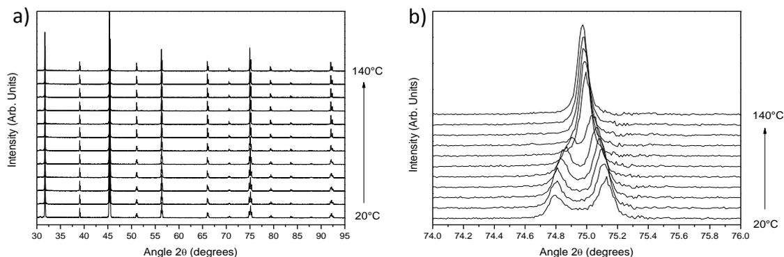
Figure III-17 : a) Diffractogrammes réalisés à différentes températures sur une pastille frittée à 1400 °C durant 3 heures ; b) zoom autour de la réflexion (013) (la radiation  $K_{\alpha 2}$  est retirée).
