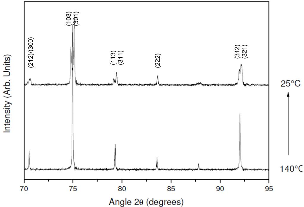
Figure III-19 : Diffractogrammes de rayons X réalisés à 140 °C puis après refroidissement à 20 °C. Ces mesures ont été réalisées sur la céramique frittée à 1400°C.
