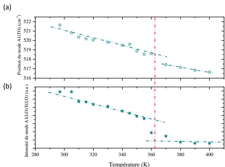
Figure III-22 : Évolution en fonction de la température (a) de la position du mode  $A_1(\text{TO})$  ( $\approx 520 \text{ cm}^{-1}$ ) (b) de l'intensité du mode  $A_1(\text{LO})/\text{E}(\text{LO})$  à  $\approx 725 \text{ cm}^{-1}$  pour un échantillon fritté à 1400 °C durant 3 heures .
