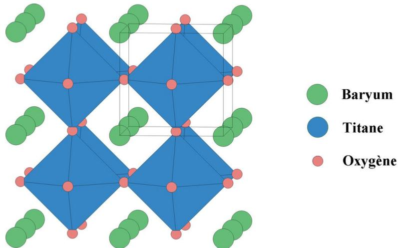
Figure I-1 : Structure Pérovskite  $\text{BaTiO}_3$  cubique à haute température [2].
