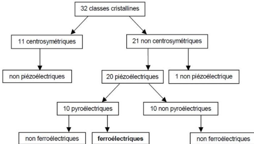
Figure I-5 : Relation entre classe cristalline et propriétés électriques.
