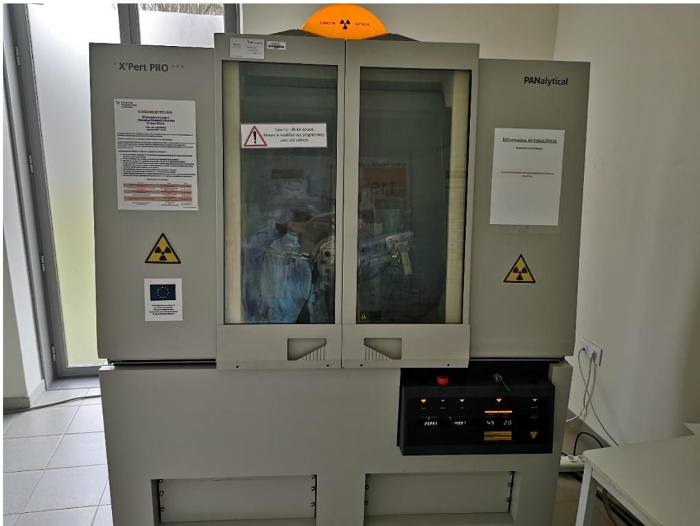
Figure II-2 : Diffractomètre de rayons X.
