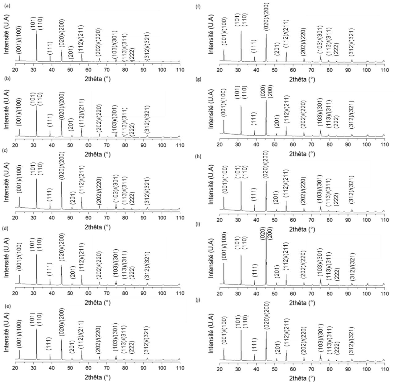
Figure IV-2 : Diffraction des rayons X réalisée sur les échantillons frittés à 1400 °C par micro-ondes durant (a) 5 min, (b) 10 min, (c) 15 min, (d) 20 min, (e) 25 min, (f) 30 min, (g) 40 min, (h) 50 min, (i) 60 min à 1400 °C de façon conventionnelle durant 3 h (j).
