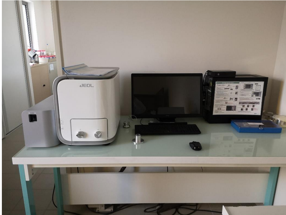
Figure II-3 : Microscope électronique à balayage de table, modèle JCM-6000 (JEOL).
