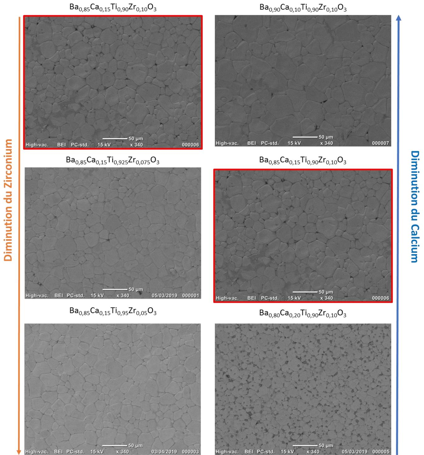
Figure V-8 : Microstructure en surfaces pour les échantillons de différentes compositions frittés à 1350 °C durant 3 heures, observe par MEB. Les images encadrées en rouge représentent la microstructure de la composition de référence.
