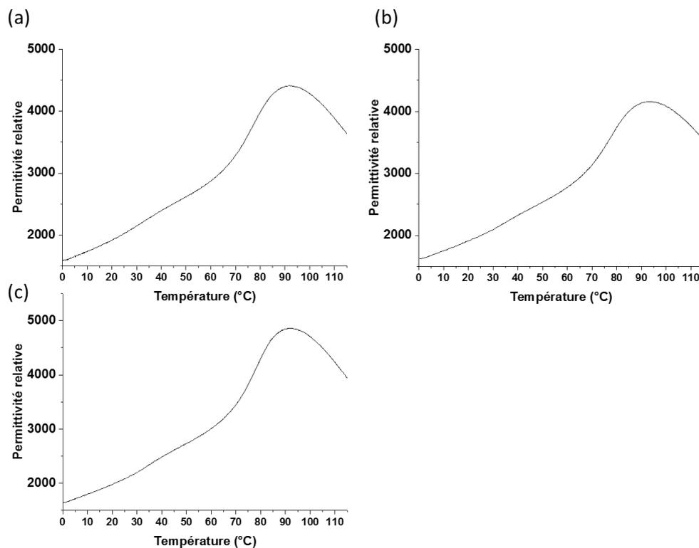
Figure IV-19 : Évolution de la permittivité relative en fonction de la température pour des échantillons (a) calciné 1 fois et fritté, (b) calciné 2 fois et fritté et (c) calciné 3 fois et fritté par micro-ondes (fréquence de mesure : 1 kHz).
