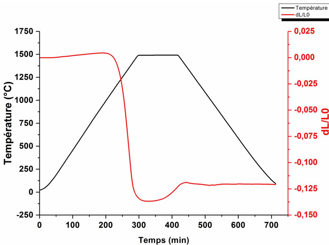
Figure 2-1 : Essai de dilatométrie réalisé sur un massif cru de BCTZ de composition de référence.
