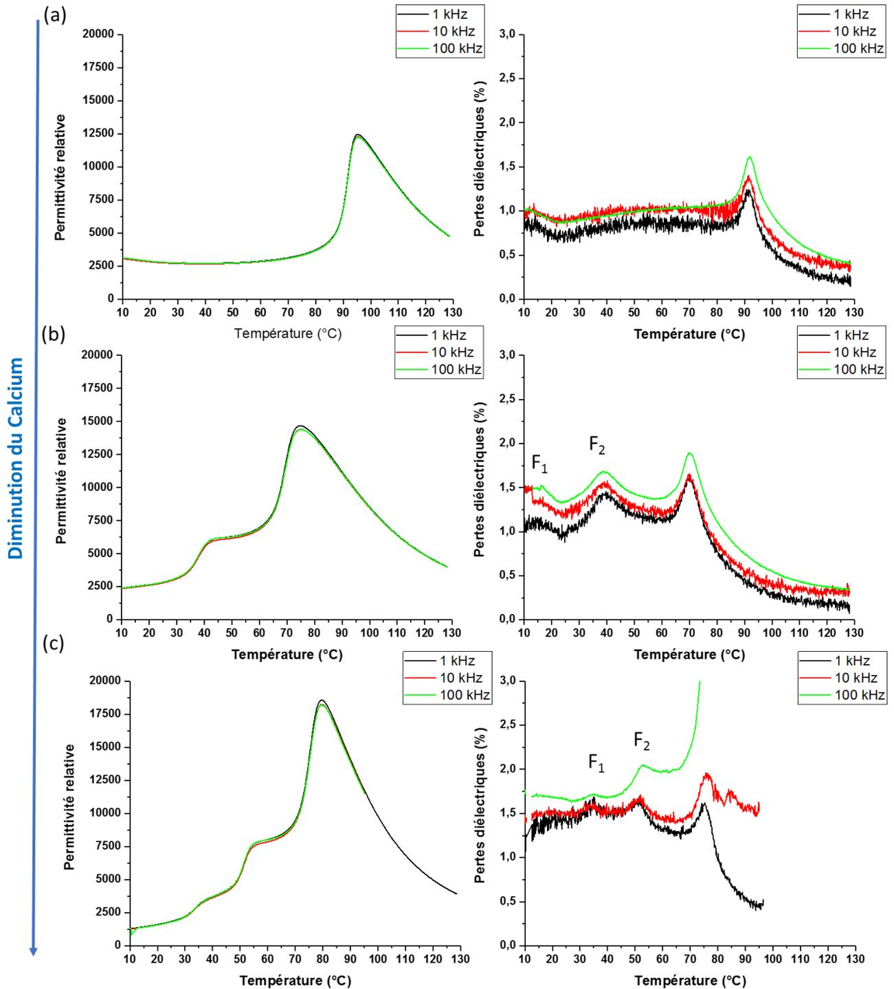
Figure V-16 : Courbes de la permittivité relative et des pertes diélectriques mesurées à 3 fréquences différentes en fonction de la température pour les compositions (a)  $Ba_{0,80}Ca_{0,20}Ti_{0,90}Zr_{0,10}O_3$ , (b)  $Ba_{0,85}Ca_{0,15}Ti_{0,90}Zr_{0,10}O_3$  et (c)  $Ba_{0,90}Ca_{0,10}Ti_{0,90}Zr_{0,10}O_3$ .
