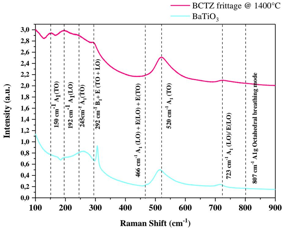
Figure III-12 : Analyse des modes normaux de BCTZ.
