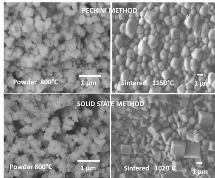
Figure I-18 : Imagerie réalisée au microscope électronique à balayage sur les poudres synthétisées (par voie solide et par la méthode Pechini) et sur les céramiques frittées de  $0,4\text{Bi}_{0,5}\text{Na}_{0,5}\text{TiO}_3-0,6\text{Ba}_{0,9}\text{Ca}_{0,1}\text{TiO}_3$ .
