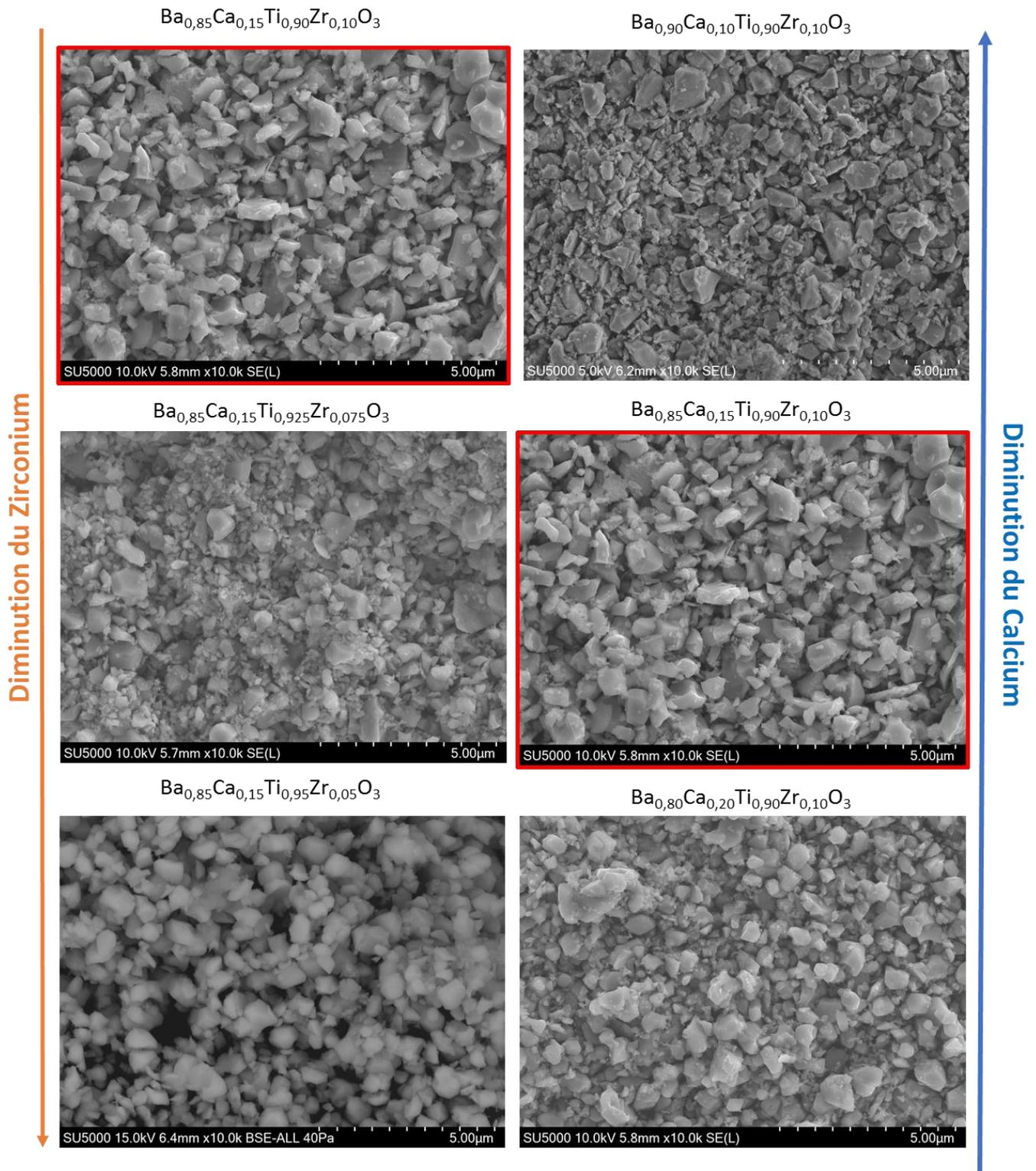
Figure V-6 : Morphologie des grains observée par MEB des poudres calcinées de différentes compositions broyées par attrition. Les images encadrées en rouge représentent la poudre calcinée broyée de la composition de référence.
