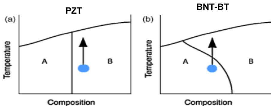
Figure I-17 : schéma des diagrammes de phases des systèmes PZT et BNT-BT.
