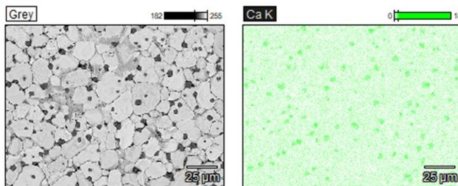
Figure V-9 : Cartographie MEB-EDS de l'échantillon fritté de composition  $\text{Ba}_{0,80}\text{Ca}_{0,20}\text{Ti}_{0,90}\text{Zr}_{0,10}\text{O}_3$ . A noter que seul l'élément calcium est représenté ici. La raie  $L_{\alpha}$  du baryum chevauche la  $K_{\alpha}$  du titane, situées respectivement à 4465 eV et 4510 eV. Il est donc compliqué de discerner correctement les deux.
