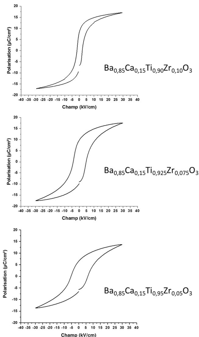
Figure V-15 : Cycles d'hystérésis réalisés à 3 kV/mm pour les échantillons dont le ratio Ti/Zr a été modifié.
