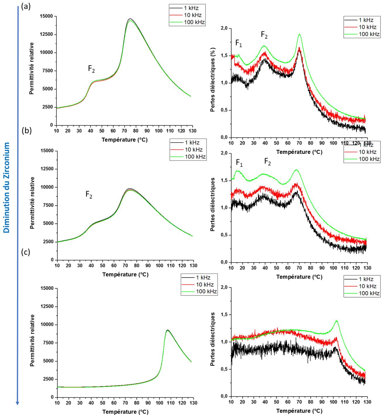
Figure V-17 : Courbes de la permittivité relative et des pertes diélectriques mesurées à 3 fréquences différentes en fonction de la température pour les compositions (a)  $Ba_{0,85}Ca_{0,15}Ti_{0,90}Zr_{0,10}O_3$ , (b)  $Ba_{0,85}Ca_{0,15}Ti_{0,925}Zr_{0,075}O_3$  et (c)  $Ba_{0,85}Ca_{0,15}Ti_{0,95}Zr_{0,05}O_3$ .
