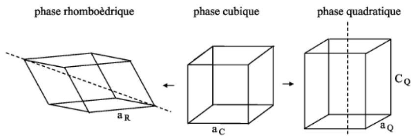
Figure I-12 : Déformations possibles de la maille PZT.
