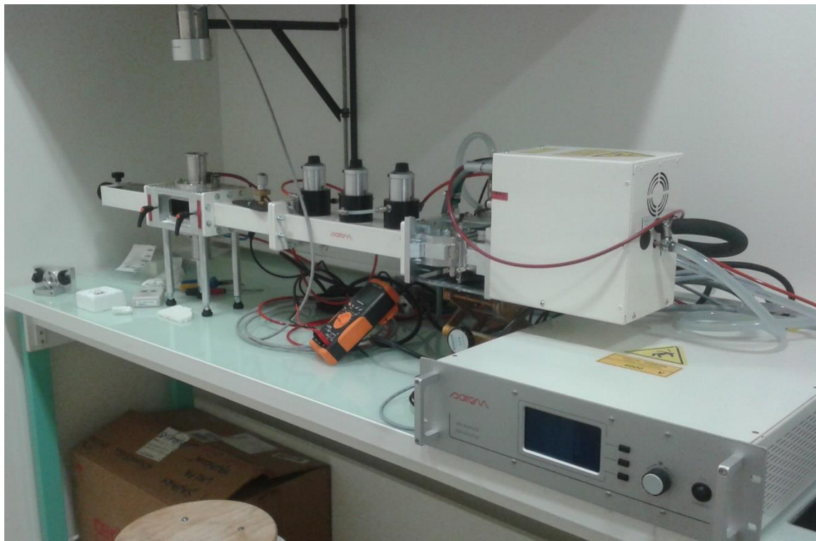
Figure II-1 : Four à micro-ondes monomode résonant à 2,45 GHz (SAIREM GMP 20 KSM, 2,45 GHz).
