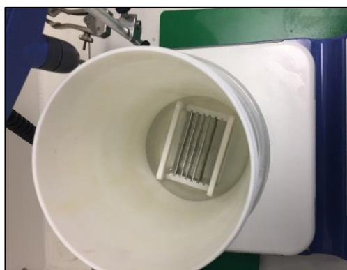
Figure III-6 : Les échantillons portés par le porte échantillons et intégrés dans le réacteur en téflon.
