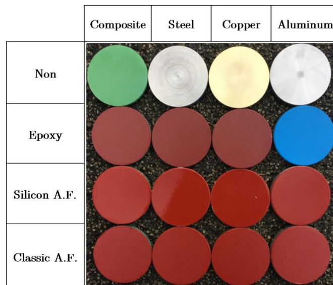
Figure II-1 : Les 4 types de substrats, Aluminium, cuivre, acier et composite couverts par les 3 types de peintures, époxy, antifouling classique et antifouling à base de silicone.
