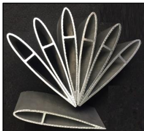
Figure IV-17 : Profils NACA avant le traitement.
