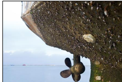
Figure I-3 : Encrassement marin (biofouling) sur un coque de bateau. Source : Reuters
