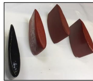
Figure IV-19 : Profils NACA avec 4 types de peintures.
