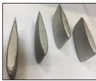
Figure IV-18 : Profils NACA avec 4 niveaux de rugosité.
