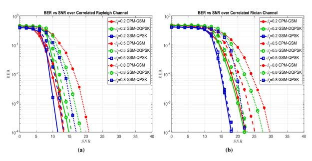
Figure 7 – Taux d'erreur pour différentes configurations dans des canaux de: (a) Rayleigh, (b) Rice.
