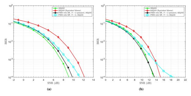
**Figure 9** – Taux d'erreur de 2-FSIM avec les filtres optimisés: (a) 5 bits/symbole avec M = 16, (b) 6 bits/symbole avec M = 32.
