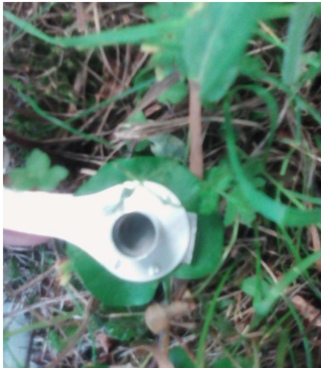
Figure 34: feuille de Soldanella alpina sur laquelle on a positionné un leaf-clip afin de faire la mesure de F_0/F_m
