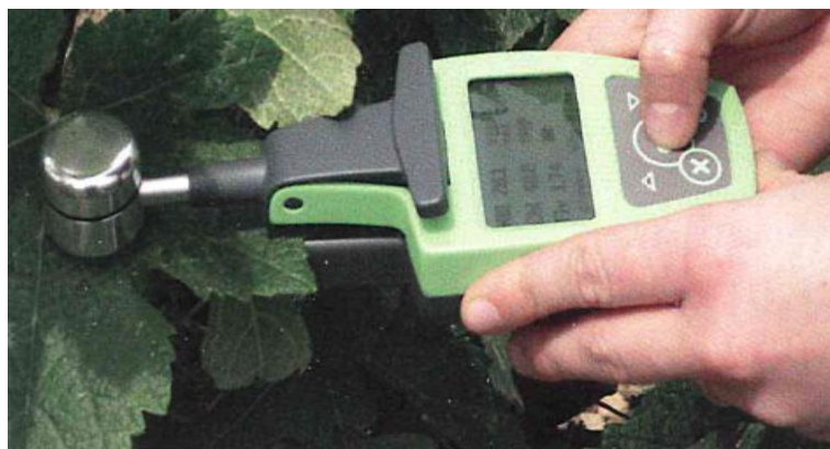
Figure 39: Mesure au Dualex 4 Scientifique d'une feuille de vigne (documentation Force A)
