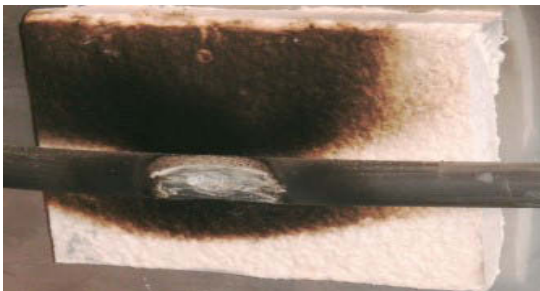
(c) Défaut dû à un arc intermittent
