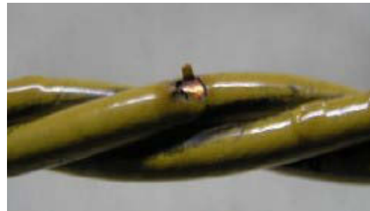
(d) Abrasion de l'isolant
