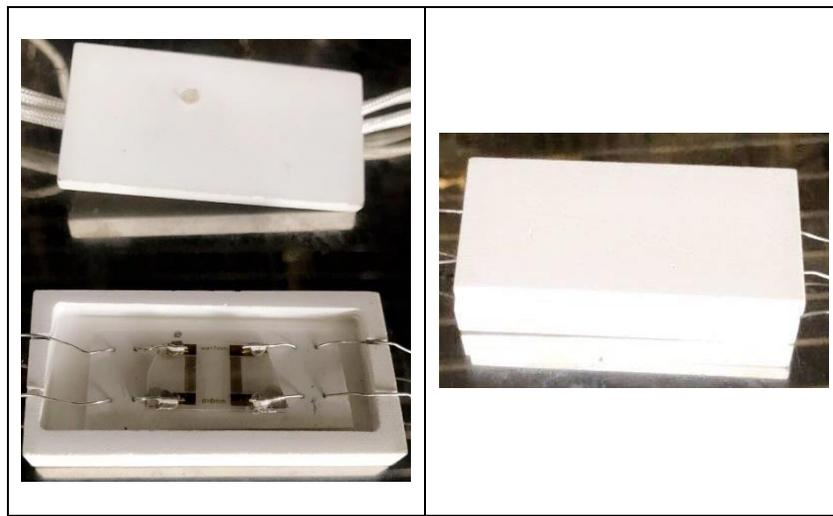
Figure 5-12 : Encapsulation du capteur SAW d'humidité
