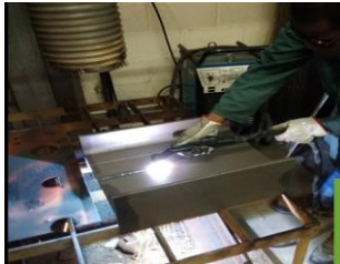
1-Découpe au plasma des poutrelles
