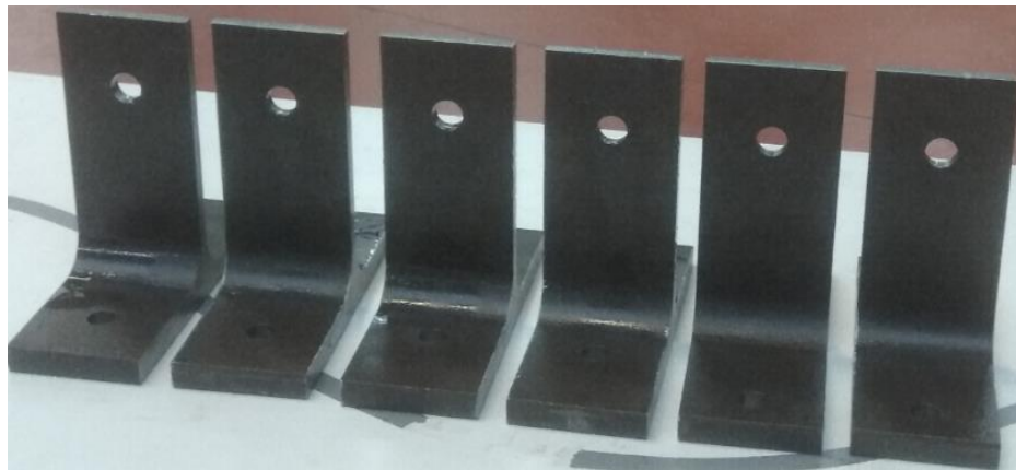
a) Semelles tirées de la poutrelle HEB 320
