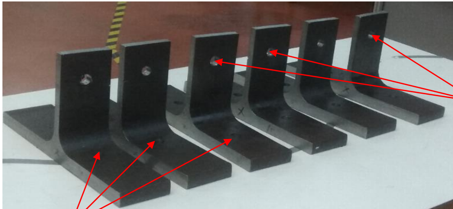
a) Semelles tirées de la poutrelle HEB 320
