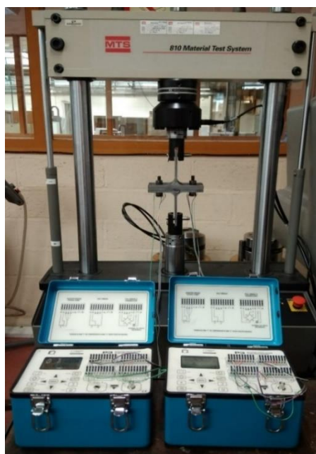
Figure 4-11 : Montage du tronçon en té provenant de la poutrelle IPE 400 sur la machine d'essai et, au premier plan, les deux ponts d'extensométrie
