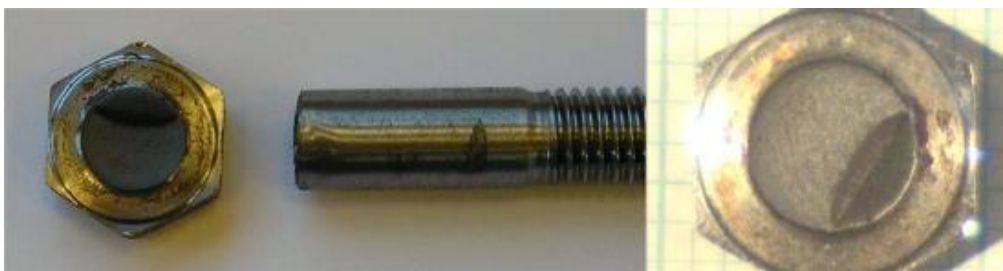
Figure 1-23 : Rupture par fatigue sous la tête d'une vis [18]
