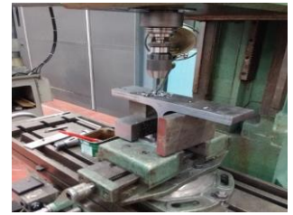
4-Perçage des trous
