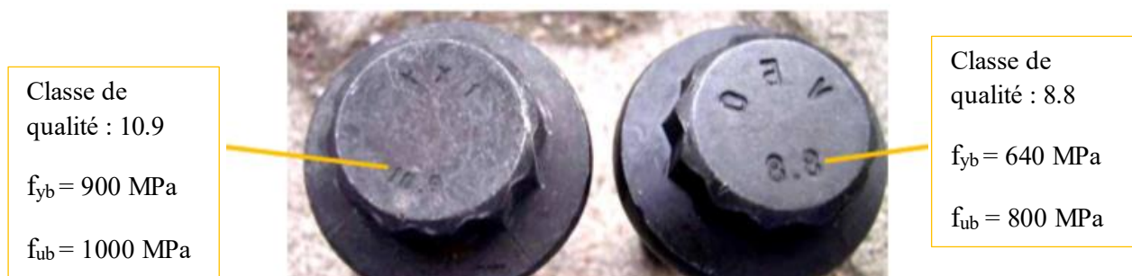
Figure 1-13 : Détermination des caractéristiques mécaniques du boulon à partir de sa classe de qualité [15]
