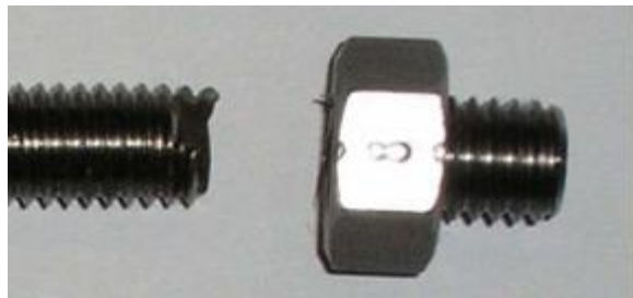
Figure 1-22 : Rupture par fatigue en fond du premier filet en prise dans l'écrou [18]
