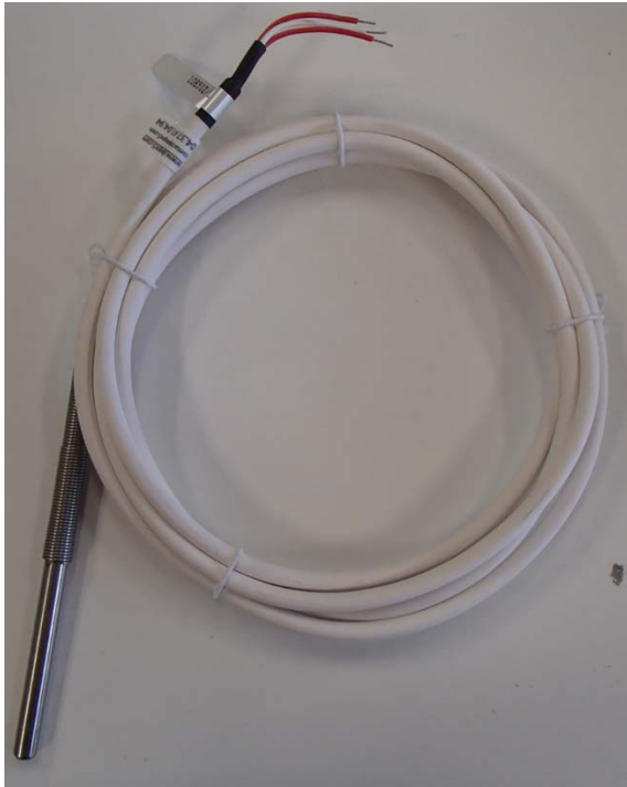
Figure 2.18 : Sonde de température PT100 installée
