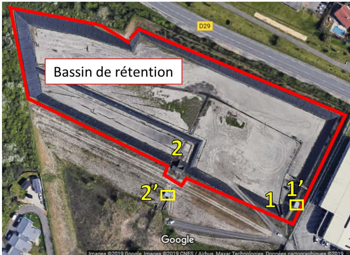
Figure 2.19 : Vue aérienne du bassin de rétention et emplacement de 1/ l'entrée du bassin de rétention (conduite d'arrivée du réseau séparatif alimentant le bassin de rétention), 2/ la sortie du bassin de rétention (conduite évacuant l'eau depuis le bassin de rétention vers le bassin d'infiltration adjacent) et leur bungalow de mesures respectif (1' et 2').
