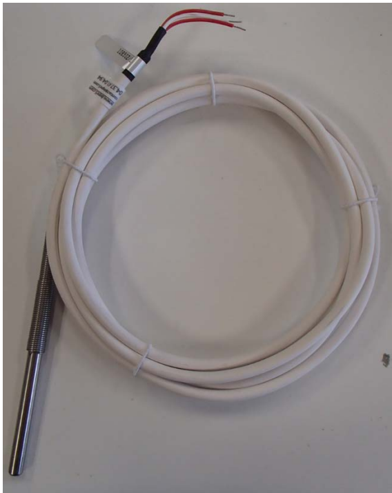
Figure 2.18 : Sonde de température PT100 installée
