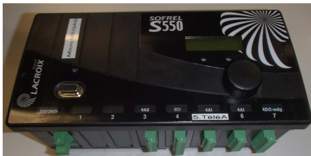
Figure 2.15 : Photo de la centrale d'acquisition sélectionnée (Sofrel S550) [1] Alimentation, [2] emplacement de la carte pour PT100, [3] Sorties analogiques pour pilotage du préleveur, [4] Entrées Digitales pour auget, [5] Entrées analogiques télé-alimentées pour conductivité, [6] Entrées Analogiques pour débitmètre électromagnétique, [7] Sorties Digitales "watchdog" pour communication de secours avec le préleveur.
