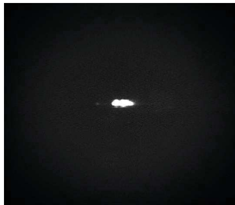
Figure C.24. Image en sortie d'un guide de 20 \mu\text{m} de large du composant GeSeTe 167-168. Cette image est caractéristique d'un guidage multimode.
