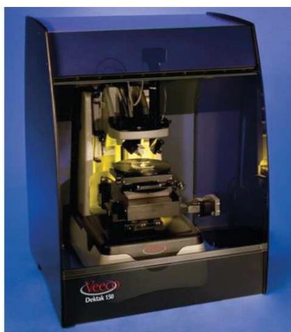
Figure C.11. Image d'un dispositif Dektak 150 et principe de fonctionnement d'un profilomètre à contact.
