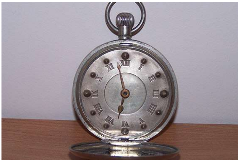
Figure 149: Montre en braille avec des aiguilles renforcées et des points surélevés pour indiquer les heures 1296 .
