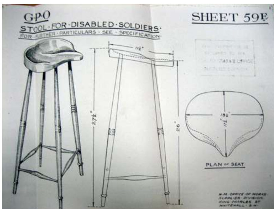
Figure 1: Le dessin d'un tabouret permettant à des vétérans blessés d'accomplir leur travail de postiers 169 .
