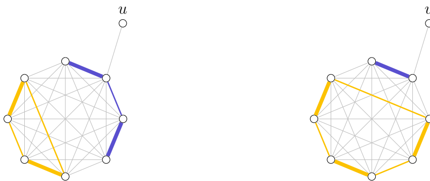
FIGURE 3.10 – Deux exemples de solutions locales dans un sous-graphe G^*(c) où c est une clique. La clique est reliée à son père par le sommet u . Les deux solutions locales contiennent un cycle alterné en jaune et un chemin alterné en bleu. À gauche la solution locale est gelée et à droite la solution locale est extensible.
