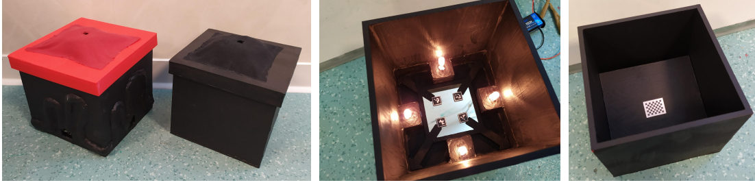
FIGURE 5.12 – Boîtes permettant la capture d'images en vue de l'étalonnage des modèle lumineux.
