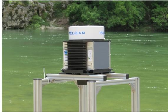
FIGURE 3.5 – Le radar Pelican développé par l’Inrae.
