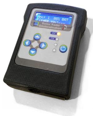
FIGURE 3.6 – Le capteur UWB développé par l’Inrae et l’Institut Pascal.
