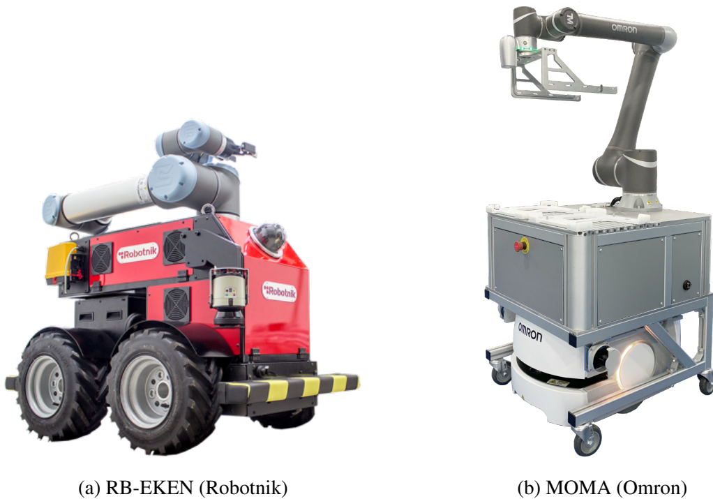
FIGURE 1.1 – Exemples de robots mobiles manipulateurs développés par les industriels Robotnik et Omron
