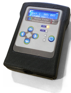
FIGURE 5.8 – Capteur de distance UWB développé par l'institut Pascal et l'INRAE
