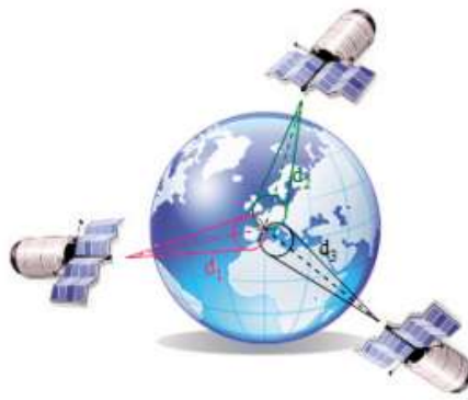
FIGURE 3.1 – Illustration du principe de triangulation pour géolocaliser un récepteur à la surface du globe. Un quatrième satellite permettra de définir l'altitude.
