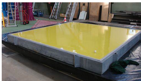
FIGURE III.4 – Photo de la dalle recouverte d'une peinture jaune reproduisant les conditions réelles d'entreposage
