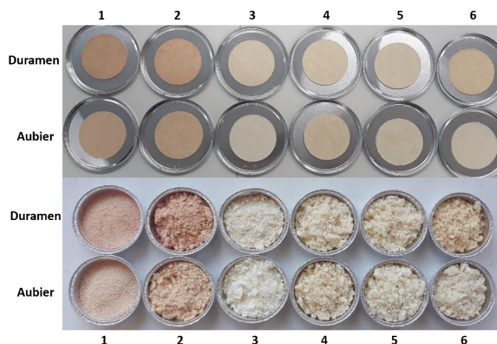
Figure 19 : Disques de duramen et aubier ayant subi différents traitements au H_2O_2 : Non traité (1), Blanc (eau) (2), 0,1 %m NaOH (3), 1 %m NaOH (4), 1,8 %m NaOH (5), 10 %m NaOH (6)
