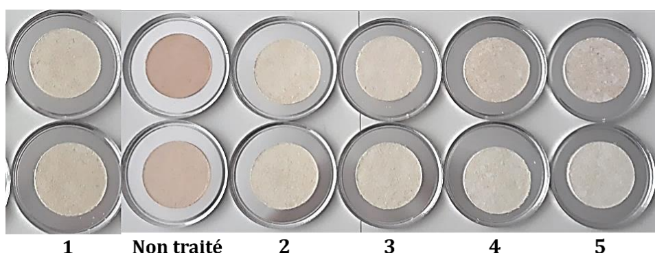
Figure 6 : Disques de duramen et d'aubier après traitement au peroxyde d'hydrogène avec différents ratio NaOH / Mg(OH)_2
