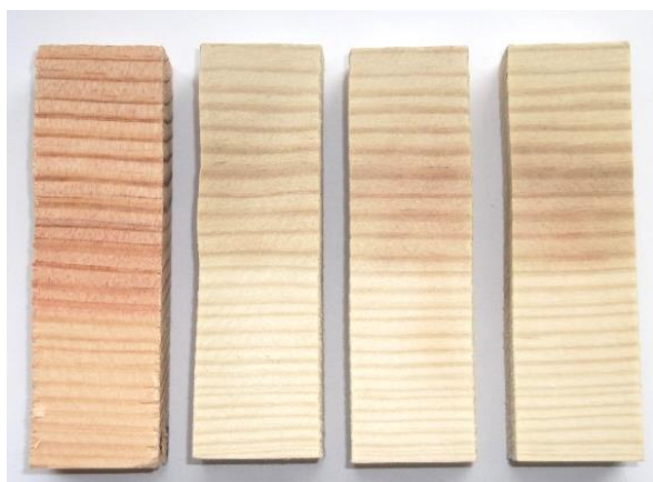
Figure 3 : Plaquettes modifiées par un traitement au peroxyde d'hydrogène (traitement par immersion, gauche : plaquette témoin)
