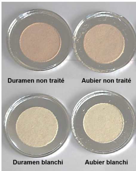
Figure 6 : Disques de bois (poudre pressée) ayant subi ou non un traitement au peroxyde d'hydrogène
