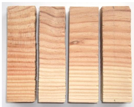
Figure 6 : Plaquettes modifiées par un traitement au peroxyde d'hydrogène (brossage, gauche : plaquette témoin)
