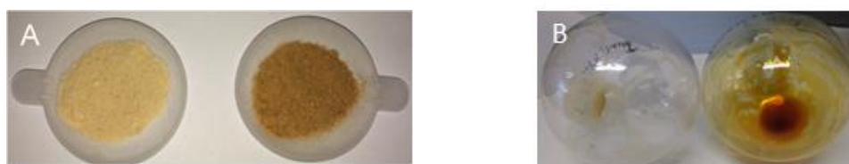
Figure 25 A : Evolution de la couleur d'un duramen ayant subi un séchage sous atmosphère oxydante (gauche : duramen non traité ; droite : duramen traité)
