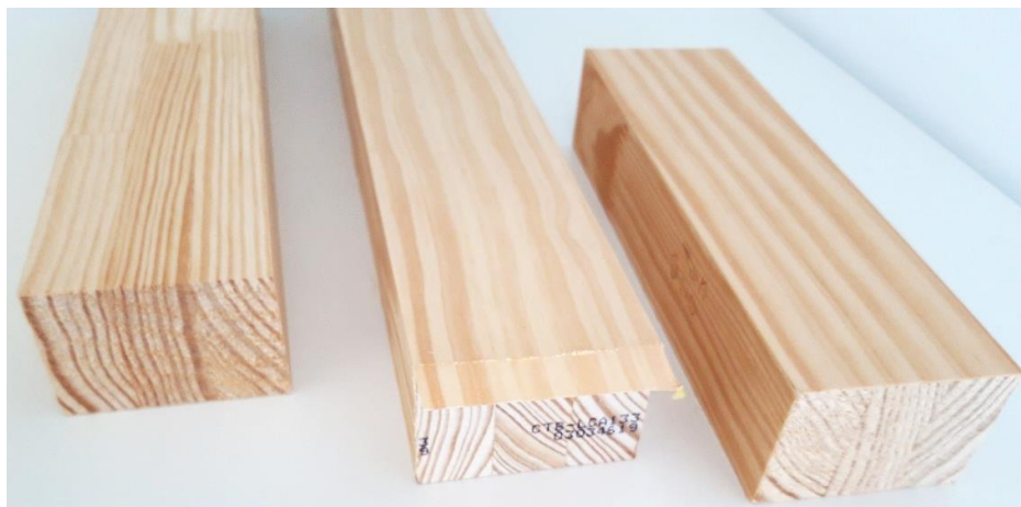
Figure 13 : Clichés de carrelets 3 plis et d'une feuille de placage en pin maritime : non plaqué (gauche), plaqué sur les points de collage (droite), placage posé sur le carrelet (centre)
