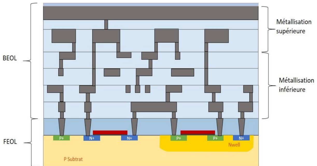
Figure 2.1 – Vue en coupe de la structure interne d'un circuit intégré.
