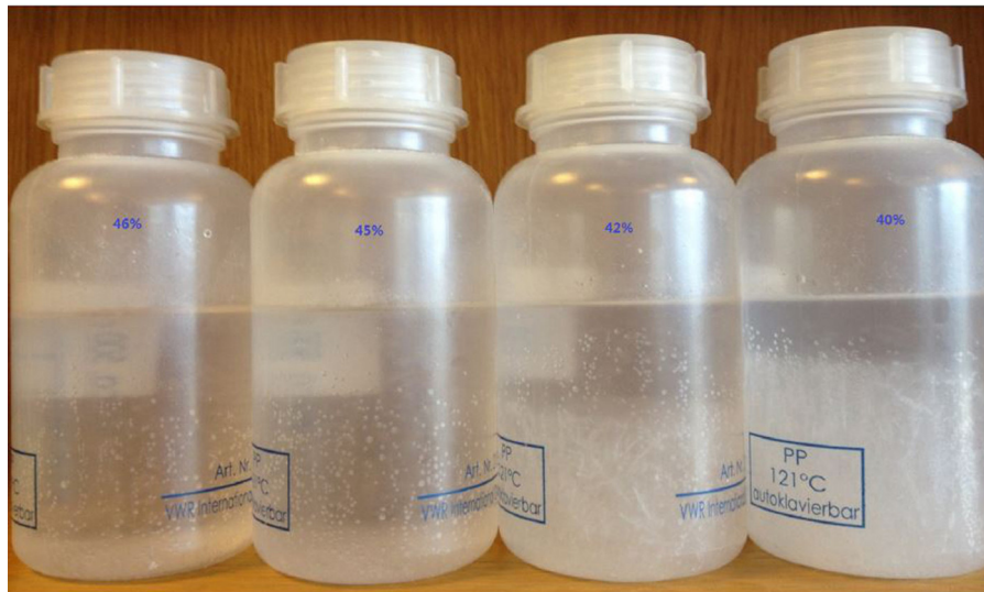
Figure 2.33 – Solutions de 8 cm de hauteur surfondues pendant 131 jours, avec une concentration X en eau et (1-X) en acétate de sodium, avec X = 46 ; 45 ; 42 et 40 % [206].
